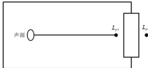
图4. 室内声源等效为室外声源图例
